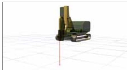
1. Bohren des Loches mit Kreuzbohrkrone
